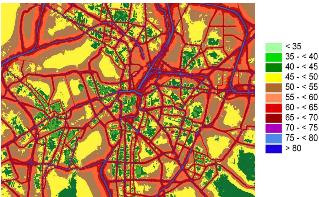
Abb. 2: Beispielhafter Auszug aus der Lärmkarte für die Belastung durch den Gesamtlärm - 24 h für Leipzig, alle Angaben in dB(A)
