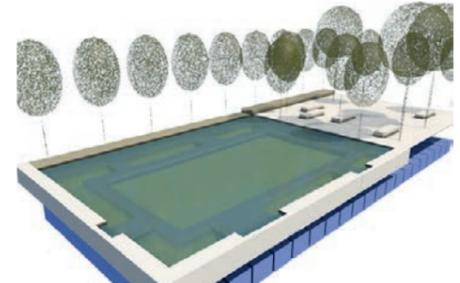
3. Im Havariefall lässt sich der komplette tiefer liegende Platzbereich einstauen, Notüberläufe in die Kanalisation o. ä.
