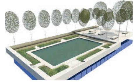
2. Wasser läuft bei gefüllten Verdunstungsbeeten über in den darunter liegenden Versickerungsbereich (Versickerung über Mulden-Rigolen-System)
