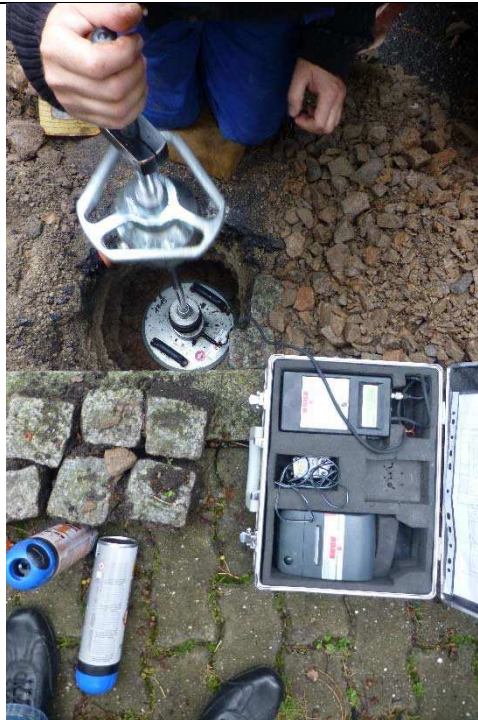
Foto Nr. 6: Durchführung der Untersuchungen mit dem „Leichten Fallgewicht“ im Schurf 3/16
