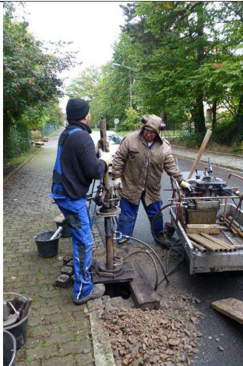
Foto Nr. 8: Ziehen der Sonde bei RKS 3/16
