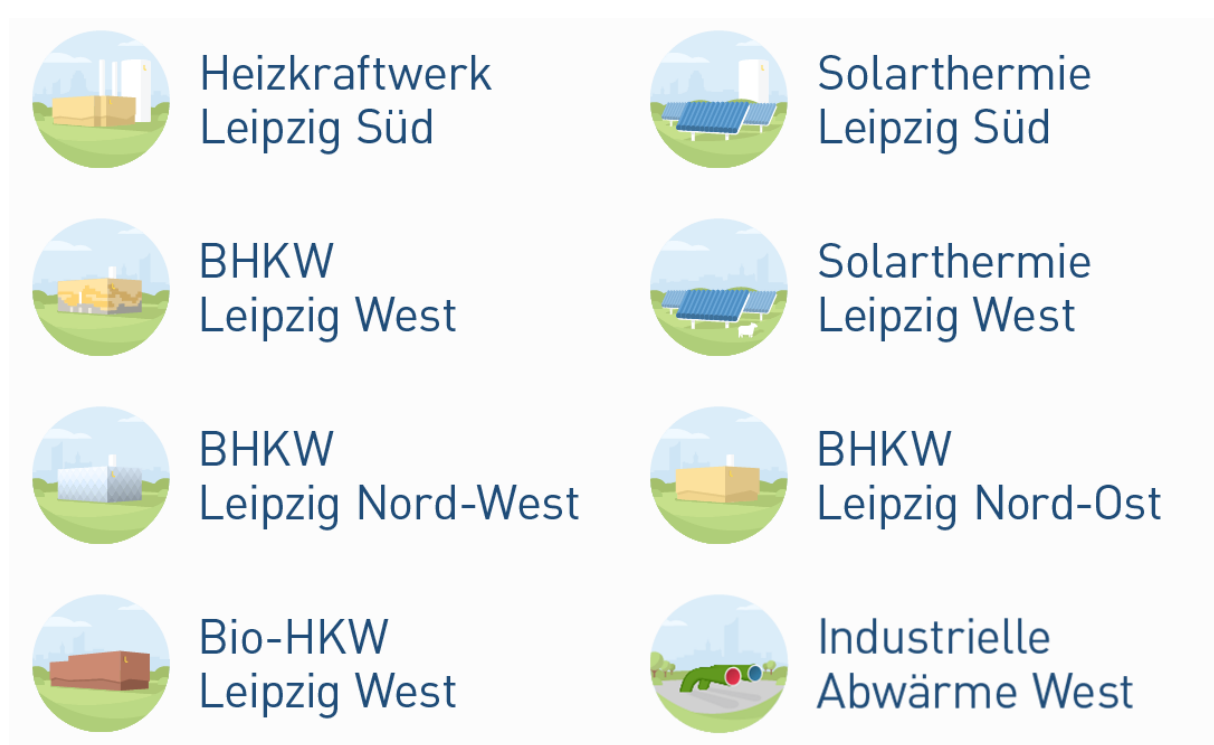
Abb. 10 Technologiemix im Zukunftskonzept Fernwärme 2030 12
