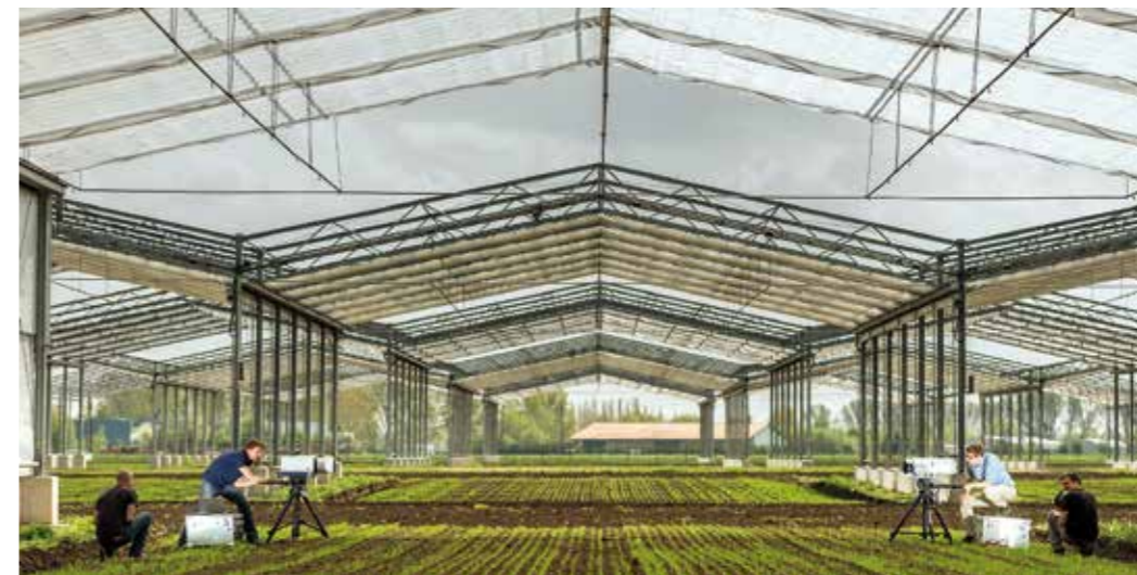
Viele der Informationen, die die GCEF in den nächsten Jahren liefern wird, werden durch ein im UFZ entwickeltes drahtloses selbstorganisierendes Sensornetzwerk gemessen und verarbeitet, eine Art WLAN-Netzwerk, in dem sich viele kleine Stationen zur Messung von Feuchtigkeit und Temperatur in Luft oder Boden sowie der Strahlungsintensität befinden. Die Dinge, die für den Betrachter sichtbar sind, sind nur ein Teil der hochmodernen Technik. Denn sie steckt überwiegend im Boden vergraben oder schwirrt als Daten durch die Luft.
