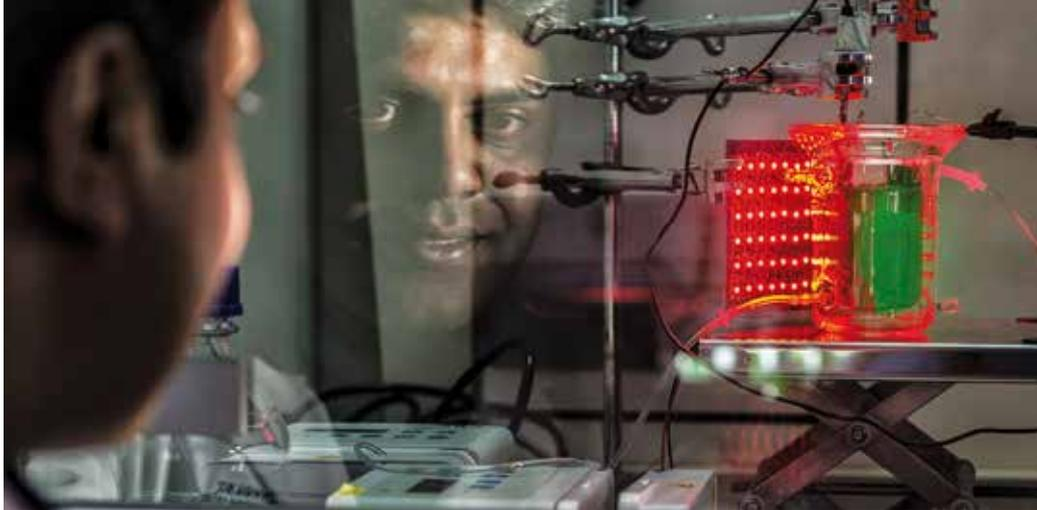
Grelles Licht scheint auf ein Becherglas mit einer grünen Flüssigkeit. Der promovierende Ingenieur Babu Halan nutzt Cyanobakterien – wie Grünpflanzen fähig zur Fotosynthese –, um mit Sonnenlicht Elektrizität und Wasserstoff zu erzeugen.
