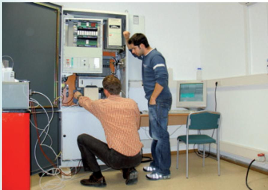
Dr. Födisch AG, Prüfung eines Messsystems
