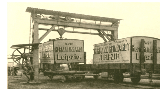
Wechselbrücke, Katalog Fa. Hermann Reinhardt – Möbelspedition und Lagerung, Leipzig 1912 (Quelle: Sächsisches Wirtschaftsarchiv)
