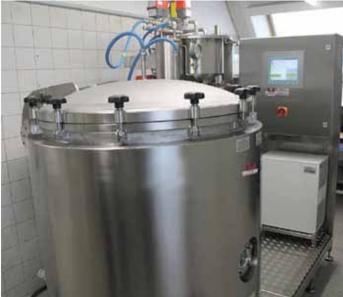
Knochen-Entfettungsanlage mit 1000 mm Kessel
